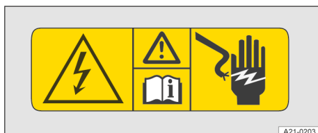
Obr. 6 Výstražný štítok v prednom priestore.
