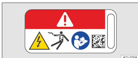
Obr. 5 Výstražný štítok na vysokonapäťových komponentoch.
