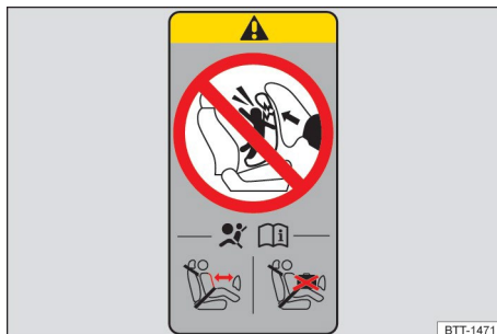
Obr. 2 Nálepka airbag na stĺpiku A alebo na stĺpiku B (principiálne zobrazenie).
